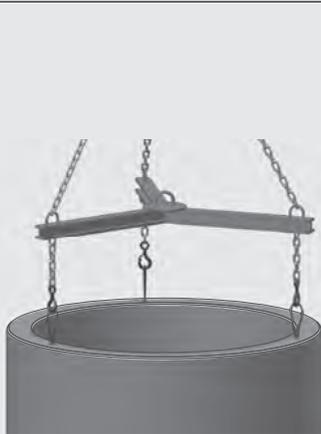
Bauteile mit Seilschlaufen
