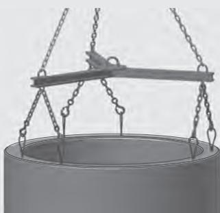
Bauteile mit Doppelanker
